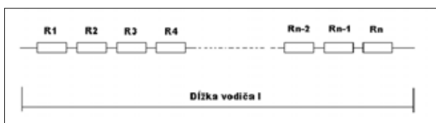
Obr. 3 Ilustrácia časti elektrického obvodu s rozloženými parametrami
