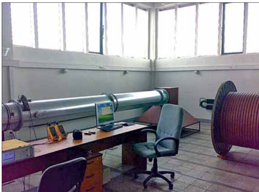
Obr. 2 Potrubie pre analýzu tepla a splodín horenia
