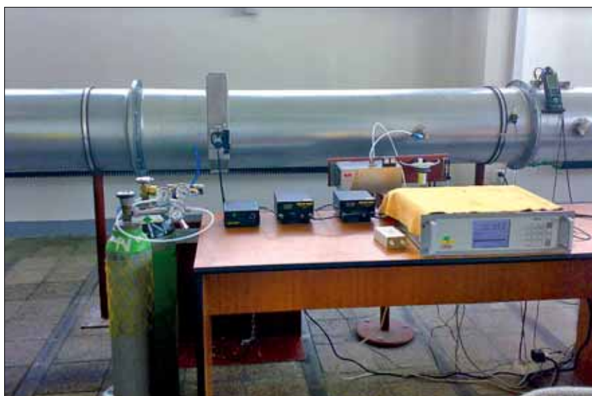
Obr. 3 Analyzátor tepla a splodín horenia s pomocnou aparátúrou
