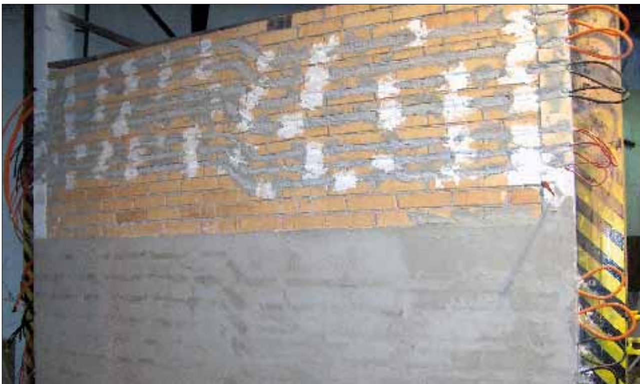
Obr. 4 Skúšobná vzorka káblov pod omietkou
