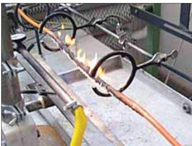
Obr. 2 Skúška podľa STN IEC 60331
