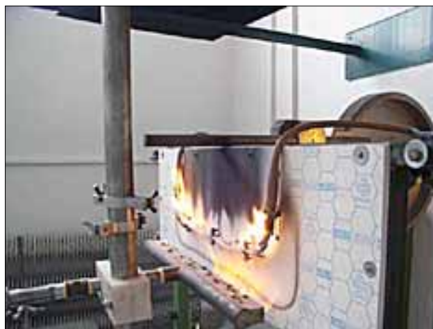
Obr. 3 Skúška podľa STN EN 50200
